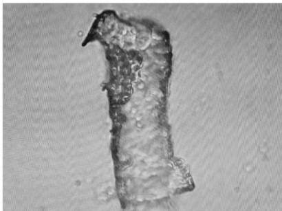
Obrázok 6 Pozdĺžne otvorené vlákno so zobákovitým zakončením a obsahom hydrogélových guľôčok.
